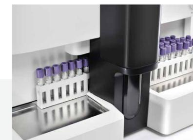
Modos de procesamiento de tubo abierto, tubo cerrado y modo de emergencia
